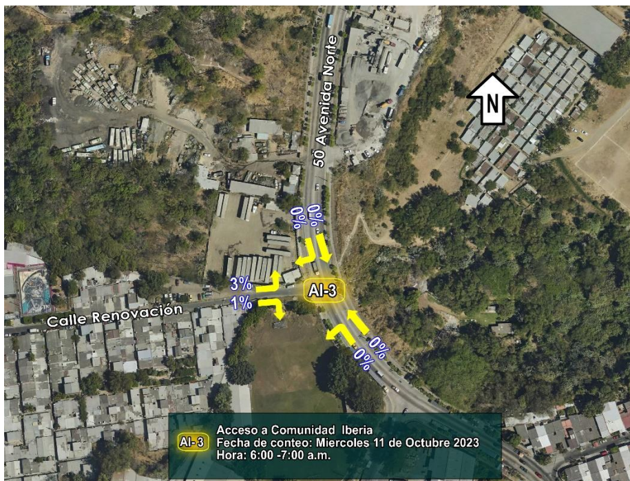
Esquema 22 Porcentaje de vehículos pesados en la hora de máxima demanda en AI-3.
