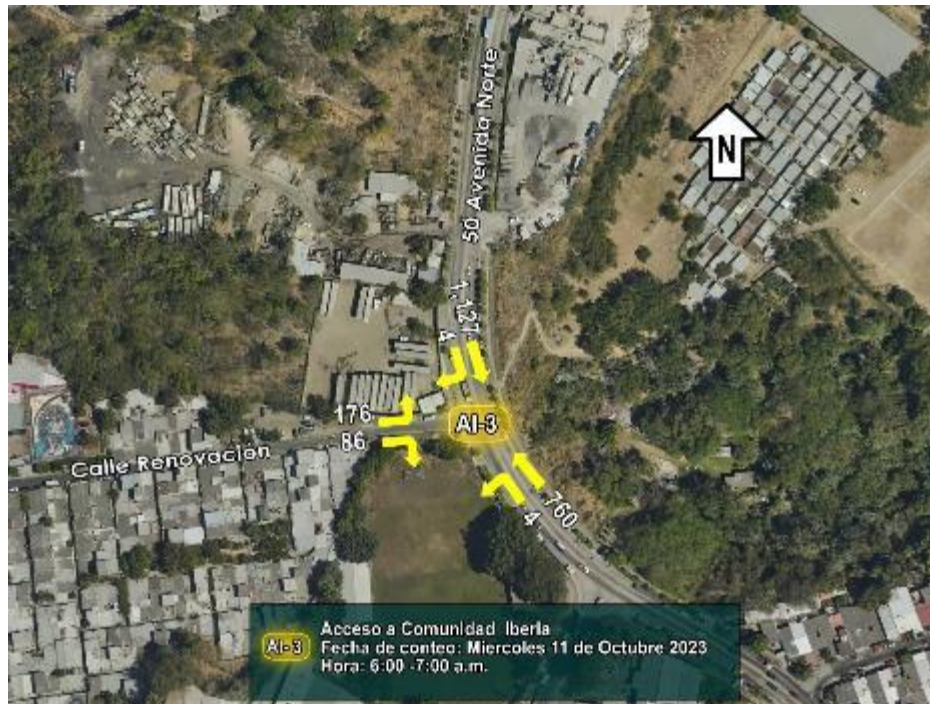
Esquema 39 Valores de tráfico en la hora de máxima demanda en AI-3, año 2040 sin proyecto.
