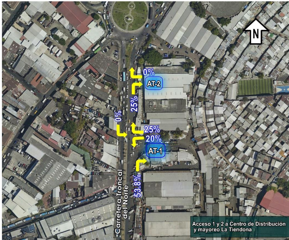
Esquema 18 Porcentaje de vehículos pesados en la hora de máxima demanda en AT-1 y AT-2
