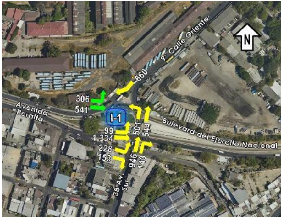
Esquema 34 Valores de tráfico en la hora de máxima demanda en I-1, 2040 sin proyecto..
