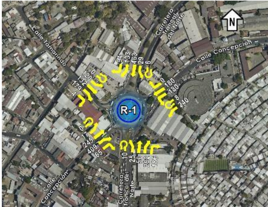
Esquema 42 Valores de tráfico en la hora de máxima demanda en R-1, año 2040 con proyecto.
