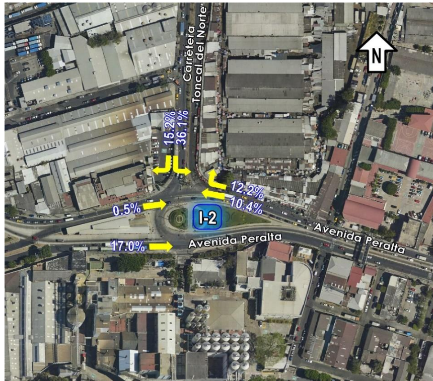
Esquema 16 Porcentaje de vehículos pesados en la hora de máxima demanda en I-2.
