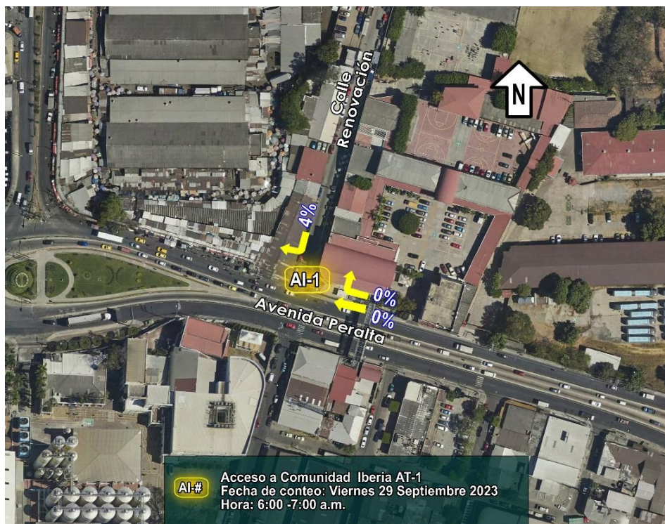
Esquema 20 Porcentaje de vehículos pesados en la hora de máxima demanda en AI-1.
