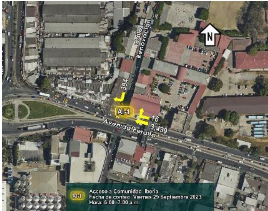
Esquema 44 Valores de tráfico en la hora de máxima demanda en AI-1, año 2040 con proyecto.
